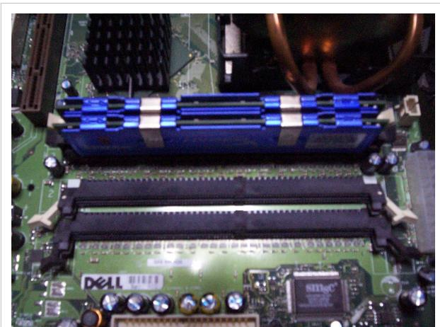
Foto de memorias RAM tipo DDR instaladas en su socket
