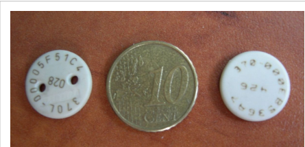
Chip Rfid HF (mejor que UHF en este entorno, debido a los procesos de lavado) "Pasivo" Encapsulado para uso en uniformidad y sector textil. Especial Lavanderías .
