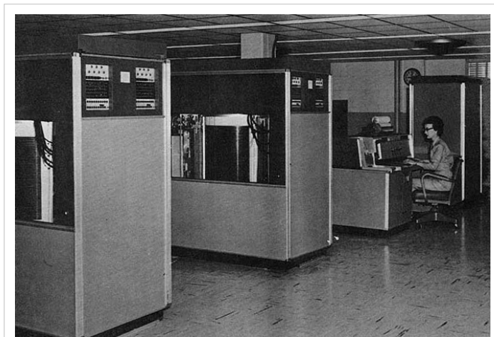
IBM 305 en el Army Red River Arsenal de los EEUU Primer plano: Dos unidades de disco 350. Segundo plano: Consola 380 y unidad de proceso 305.
