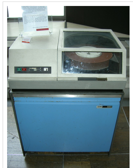
Unidad IBM 2311, con sus seis platos.
